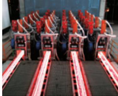
弧形连铸圆管坯生产线
